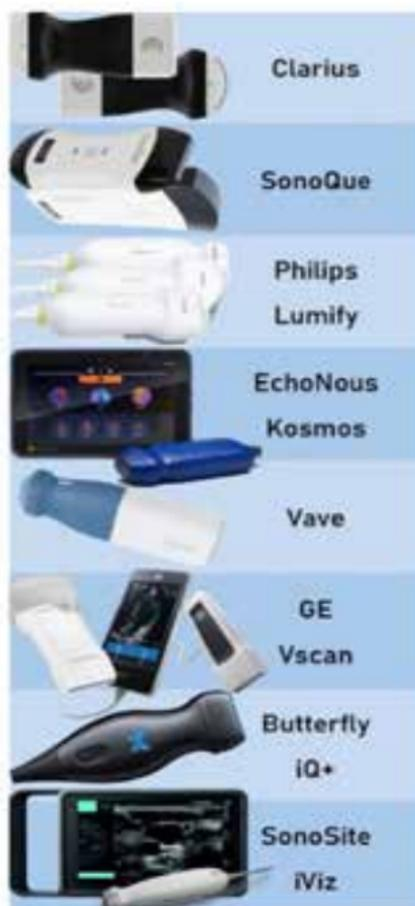
**FIGURA 2.** Dispositivos en el mercado para realización de ecografía a pie de cama.
